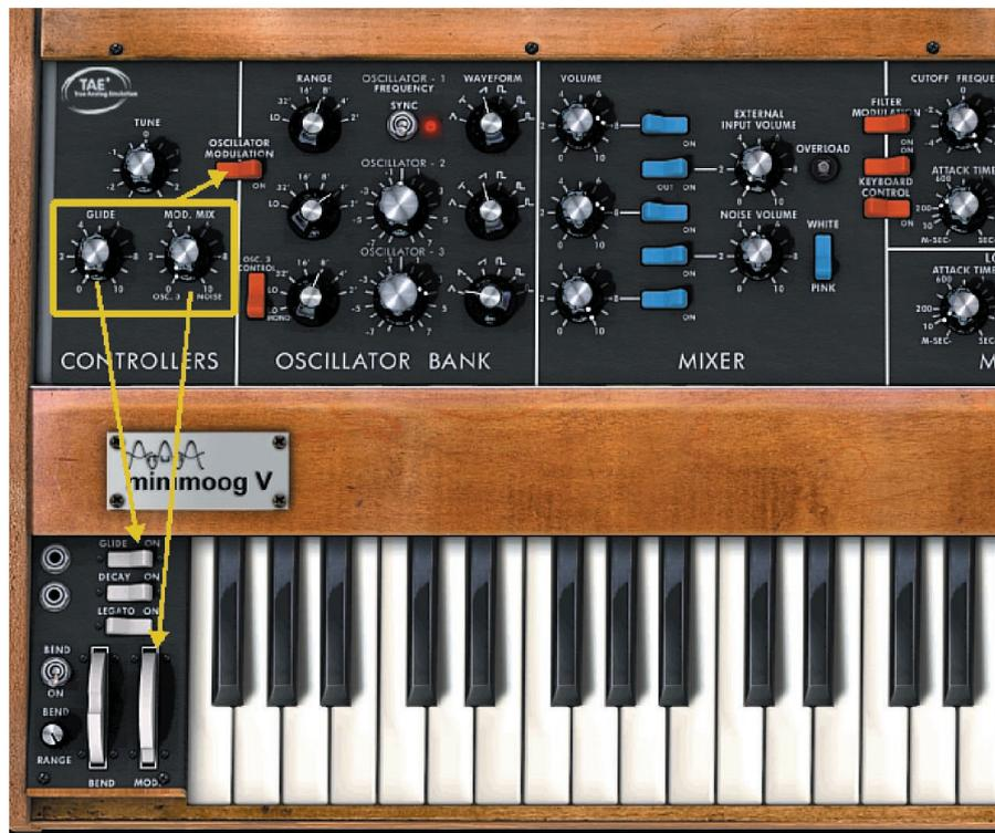
Fig. 12 – controlli da attivare per consentire l'azione del "Glide" e del "Mod. Mix"
