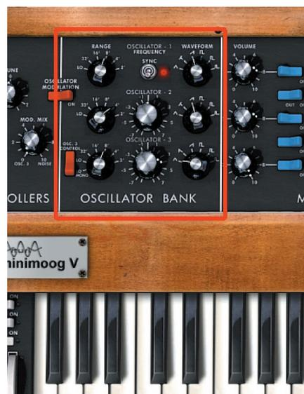
Fig.8 – sezione "Oscillator Bank" del Minimoog V
