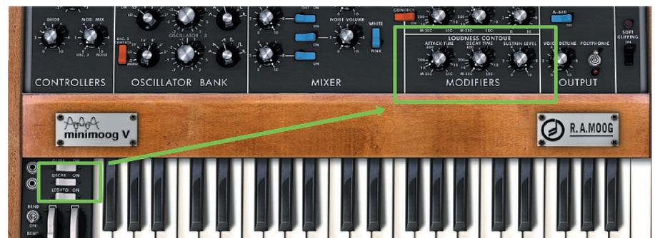
Fig. 11 - Generatore d'involuppo (EG) applicato al volume del *Minimoog V*
