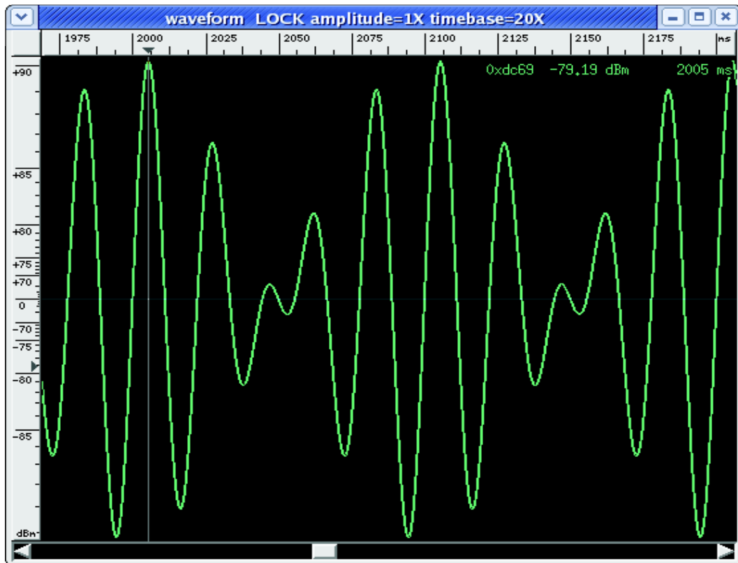
Figura 10: Sovrapposizione di due onde sinusoidali dalla stessa ampiezza e frequenza differente; Unimore 2008.
